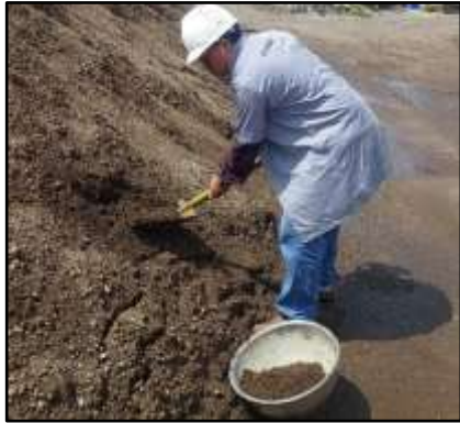
Pengambilan Material Agregat Halus
