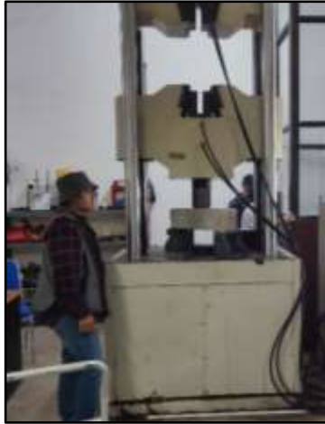
Pengujian Kuat Lentur Beton
