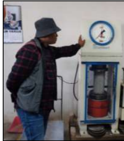
Pengujian Kuat Tekan Beton
