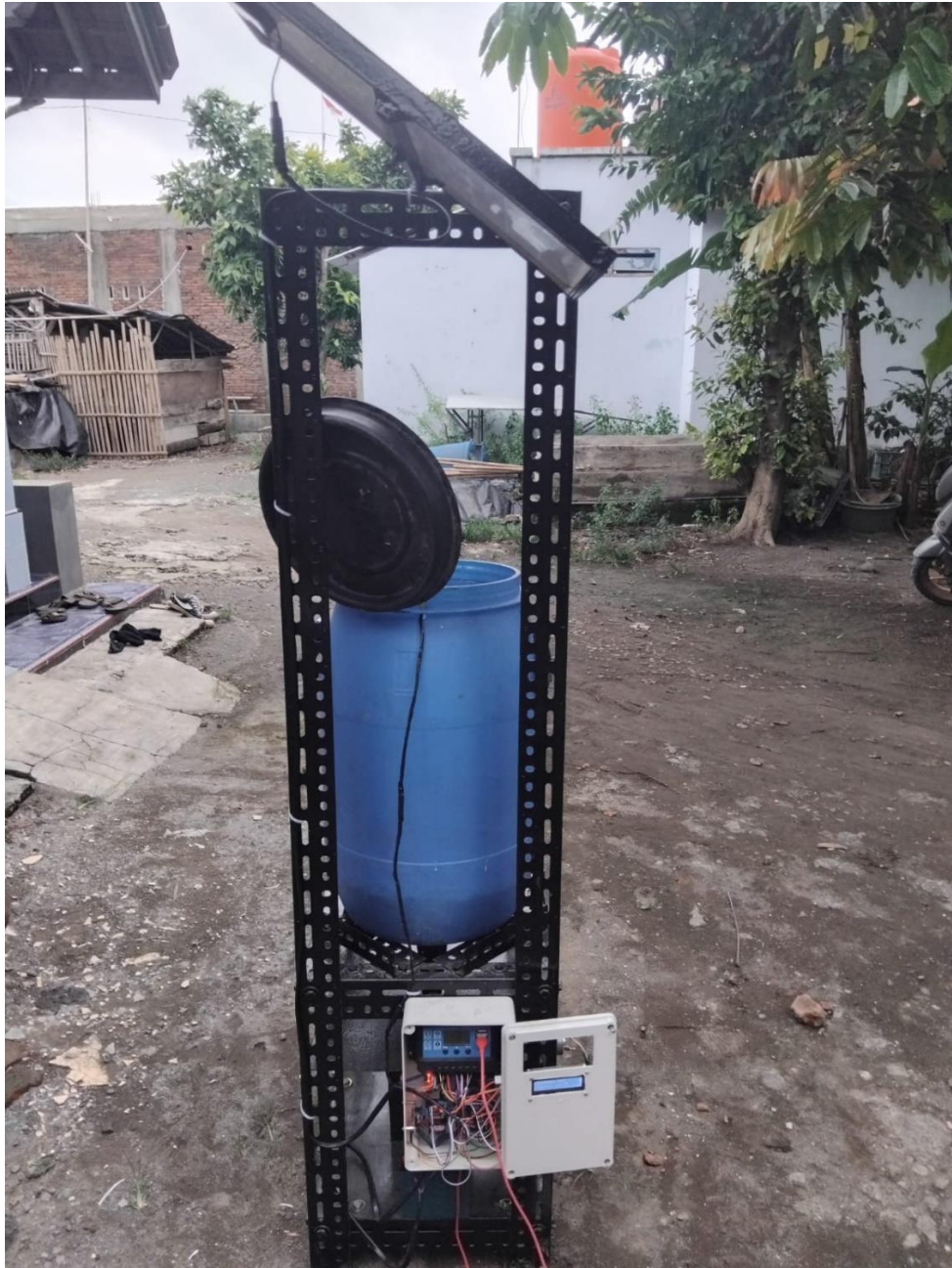
Gambar 5. 4 Alat Pemberi Pakan Ikan Otomatis
