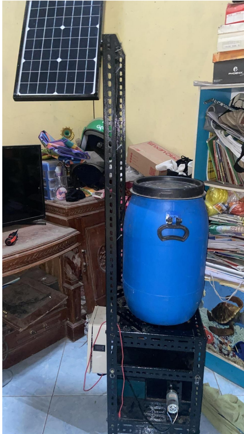
Gambar 5. 7 Alat Pemberi Pakan Ikan Dari Samping
