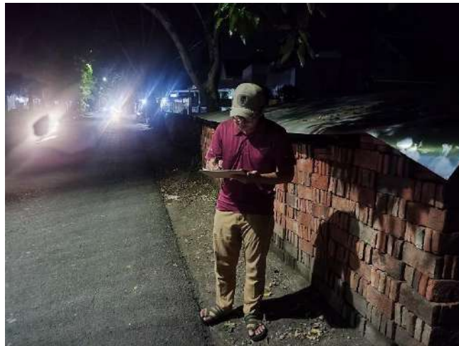
Pencatatan data Pengukuran lux pada lampu PJU di Jalan Gajah Mada
