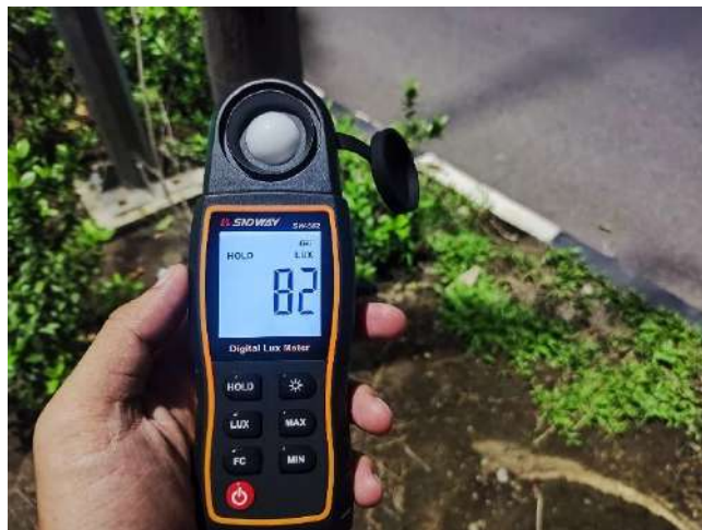
Pengukuran lux pada lampu PJU di Jalan Gajah Mada menggunakan lux meter
