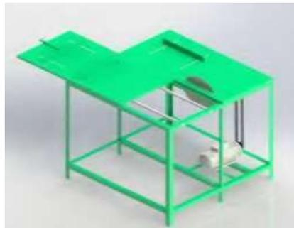
Gambar 3.3 : Mesin pemotong kayu dengan meja geser
