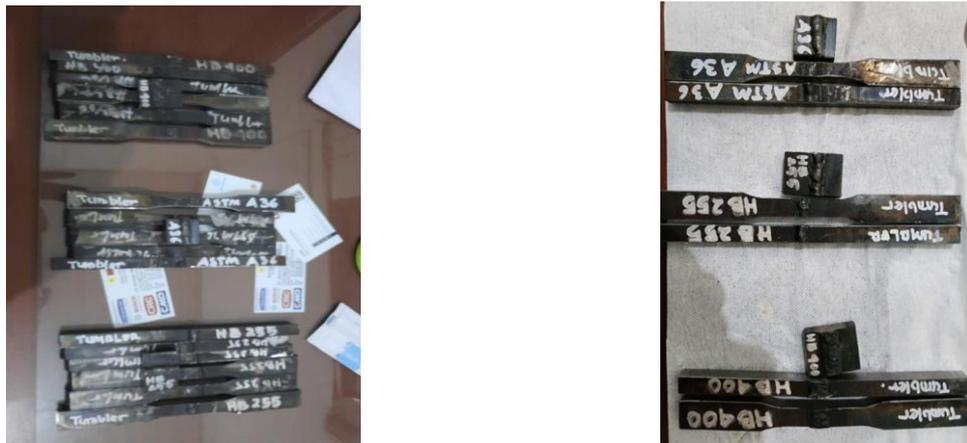
**Gambar 3. 7 Hasil Spesimen**
