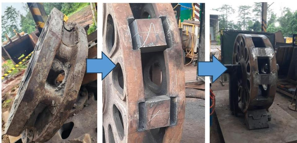
**Gambar 3. 8 Desain dan Tumbler yang dilakukan Repair**
