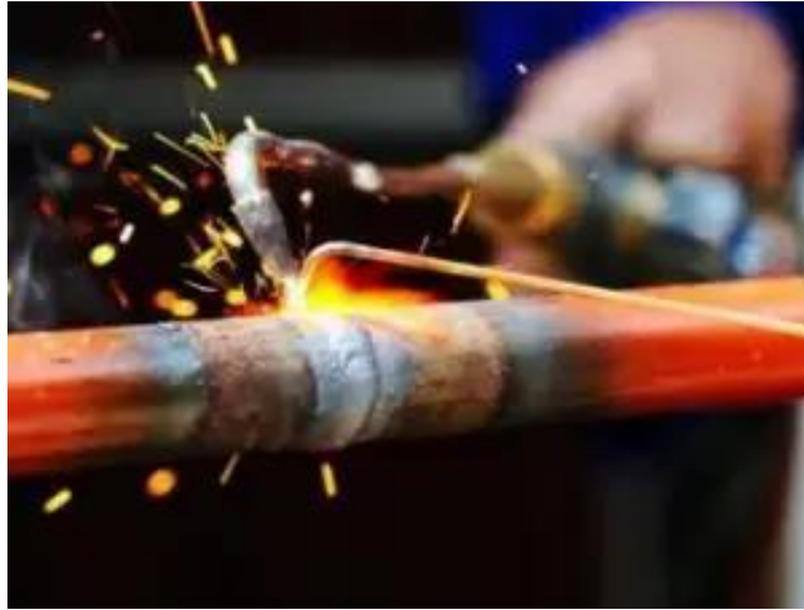
**Gambar 2.8 Pengelasan gas oksifuel**
