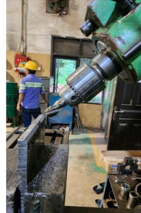
**Gambar 3. 6 Proses pemotongan Spesimen**
