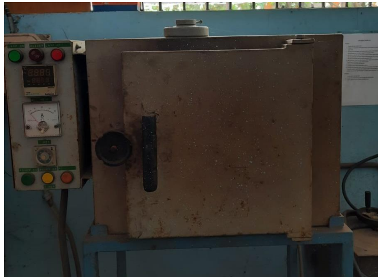
Gambar 3. 1 Alat Furnace/ Tungku pemanas
