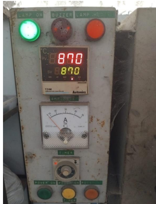
Gambar Lampiran 2.2 Heat Treatment dengan suhu 870°C
