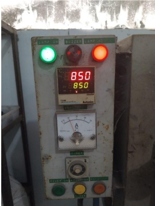
Gambar Lampiran 2.1 Heat Treatment dengan suhu 850°C
