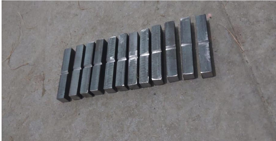
Gambar Lampiran 1. 1 Spesimen Benda Uji Impact
