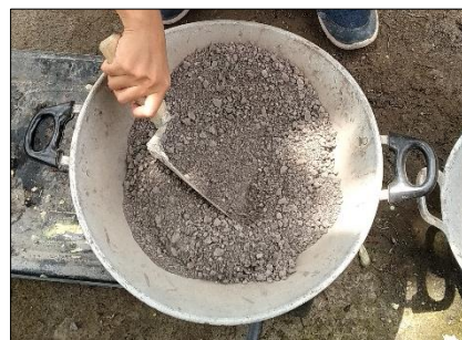
Gambar 18. Pengeringan Agregat Halus
