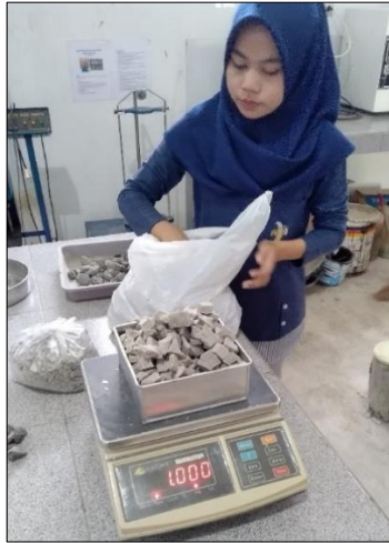
Gambar 13. Penimbangan Material sebelum Pengujian
