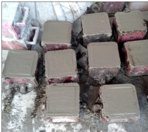
Gambar 9. Cetakan Kubus Beton
