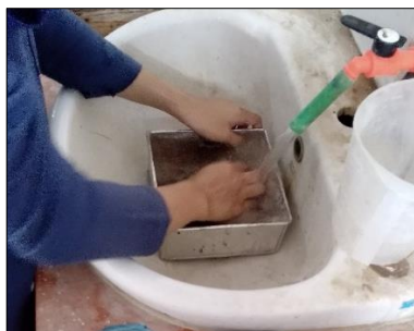
Gambar 17. Pencucian agregat Halus
