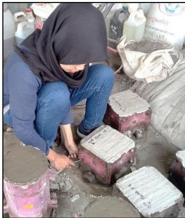
Gambar 21. Melepaskan beton dari molding/cetakan
