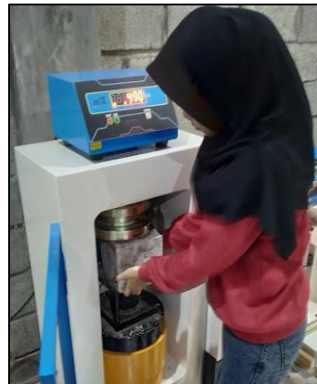
Gambar 22. Pengujian kuat tekan beton
