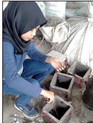
Gambar 20. Molding dilapisi oli sebelum digunakan
