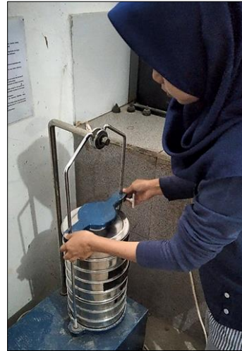
Gambar 14. Pengujian Gradasi Agregat
