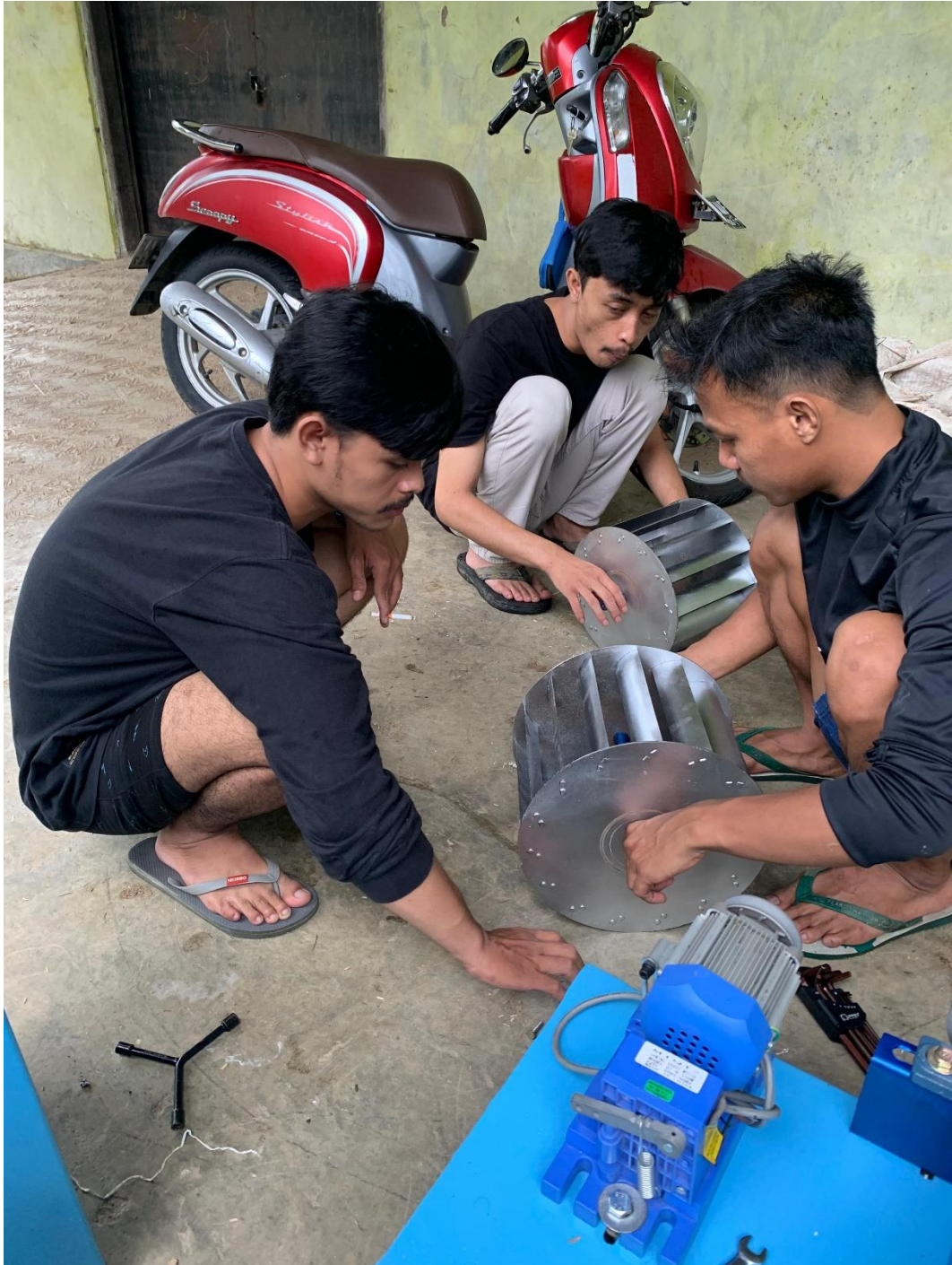
1. Proses pemasangan runner (sudu) pada rumah turbin
