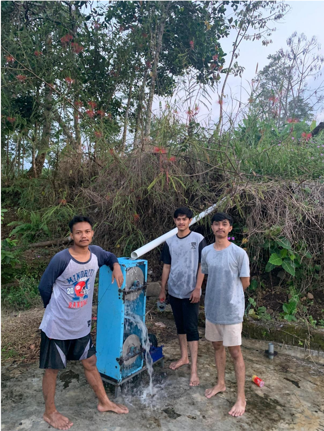
2. Proses uji coba (simulasi) turbin air crossflow di selip
