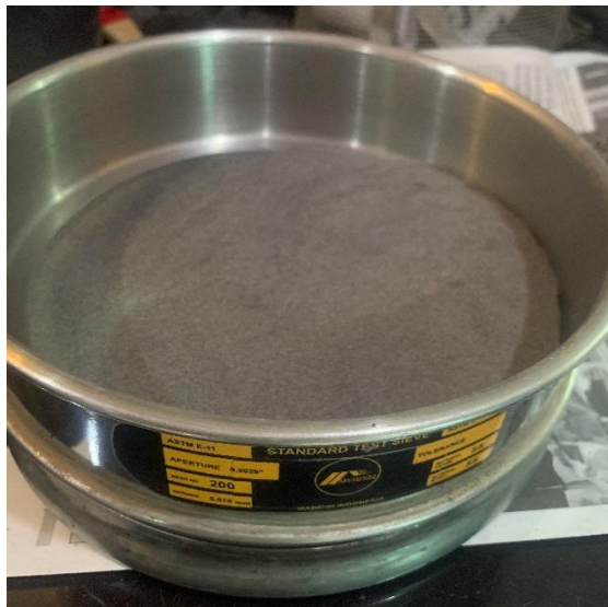
Gambar 3.27 Pengayakan Abu Serabut Kelapa Menggunakan Saringan (Sumber: Laboratorium Teknik Sipil UPS Tegal)
