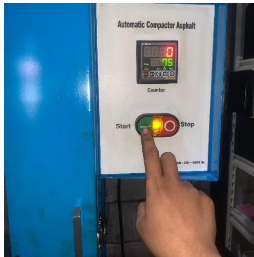
Gambar 3.36 Proses penumbukan benda uji selama 75 kali (Sumber : PT. BABN)
