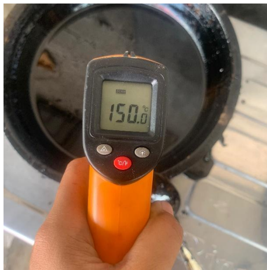
Gambar 3.32 Pemanasan aspal dengan suhu mencapai 150°C (Sumber : PT. BABN)
