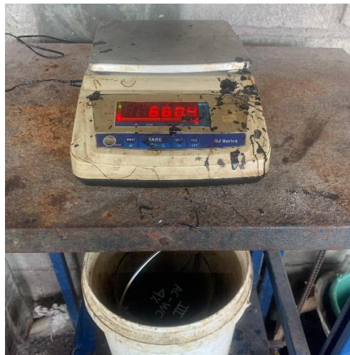
Gambar 3.43 Menimbang benda uji dalam air
