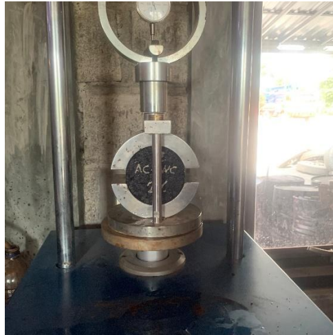
Gambar 3.36 Benda uji dipasang pada alat penguji (Sumber : PT. BABN)
