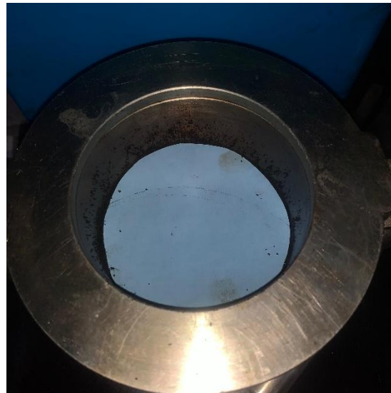
Gambar 3.35 Pelapisan kertas penghisap pada permukaan cetakan
