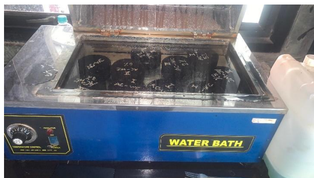
Gambar 3.35 Merendam benda uji dalam water bath (Sumber : PT. BABN)
