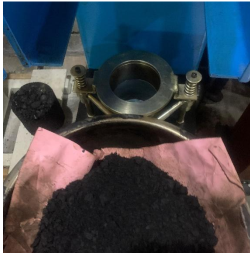
Gambar 3.33 memasukan benda uji ke dalam mold (Sumber : PT. BABN)
