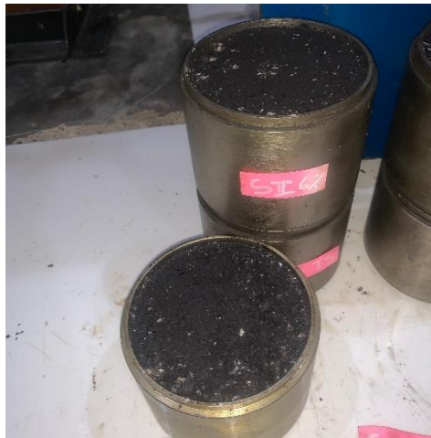
Gambar 3.39 Mendingkan benda uji selama 24 jam (Sumber : PT. BABN)
