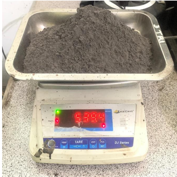
Gambar 3.28 sampel Abu Serabut Kelapa yang sudah di ayak (Sumber: Laboratorium Teknik Sipil UPS Tegal)
