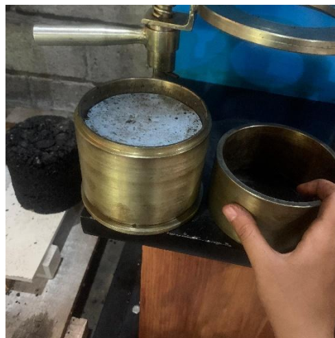
Gambar 3.37 Membalik benda uji untuk ditumbuk kembali (Sumber : PT. BABN)
