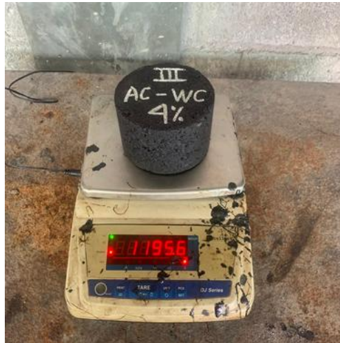
Gambar 3.34 Menimbang benda uji SSD (Sumber : PT. BABN)
