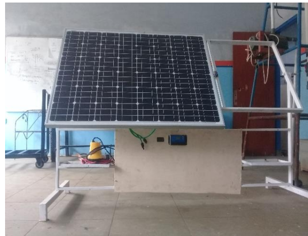
Gambar 2. Mesin Pompa Air tenaga surya.
