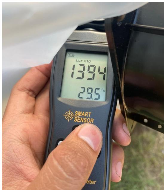
Pengukuran intensitas cahaya dengan lux meter pada ruangan pengeringan rumah kaca
