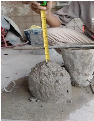
Uji Slump Test
