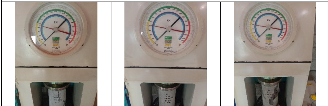
Kuat Tekan Beton ASGKK 15% Umur 28 Hari
