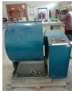
Uji Dengan Mesin Los Angeles
