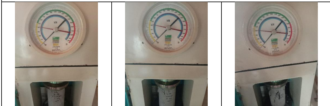
Kuat Tekan Beton ASGKK 10% Umur 28 Hari
