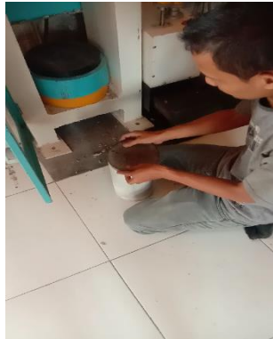
Capping beton menggunakan alas besi
