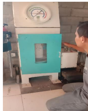
Setelah jarum hitam menurun lalu matikan alat uji kuat tekan
