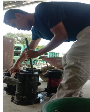
Dengan dipukul menggunakan palu karet agar adonan beton merata
