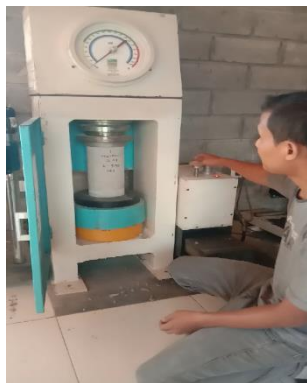
Putar pengaturan untuk uji kuat tekan silinder beton
