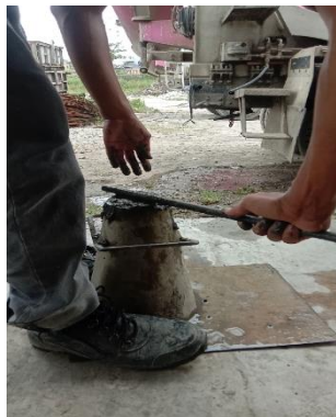
Jika sudah penuh ratakan beton yang sudah ditumbuk dengan tongkat besi
