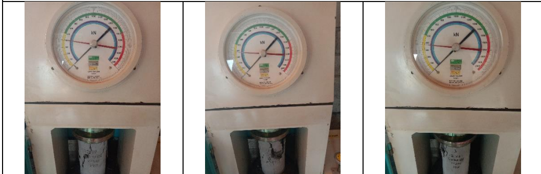
Kuat Tekan Beton ASGKK 10% Umur 14 Hari
