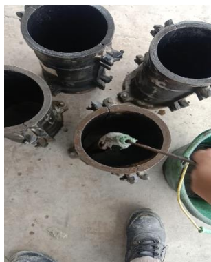
Jika slump sudah masuk sesuai mix desain lalu siapkan cetakan silinder dengan melumasi bagian dalamnya
