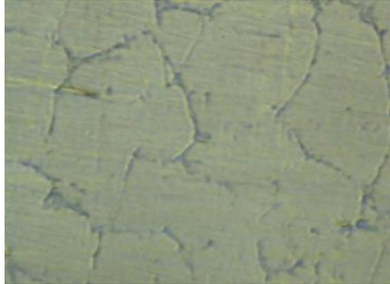
**Gambar 6.** Hasil foto mikro sepatu rem motor orisinil. Dengan pembesaran (200x)
