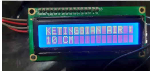
Gambar 9 Pengujian menggunakan LCD I2C
