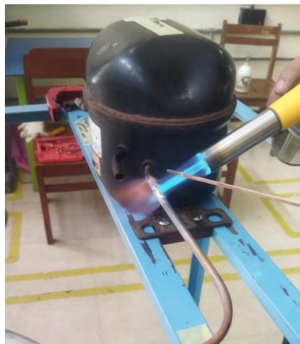
Proses Pengelasan Pipa Saluran Mesin ORC
