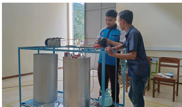
Proses Uji Kebocoran Pipa Saluran Mesin ORC
