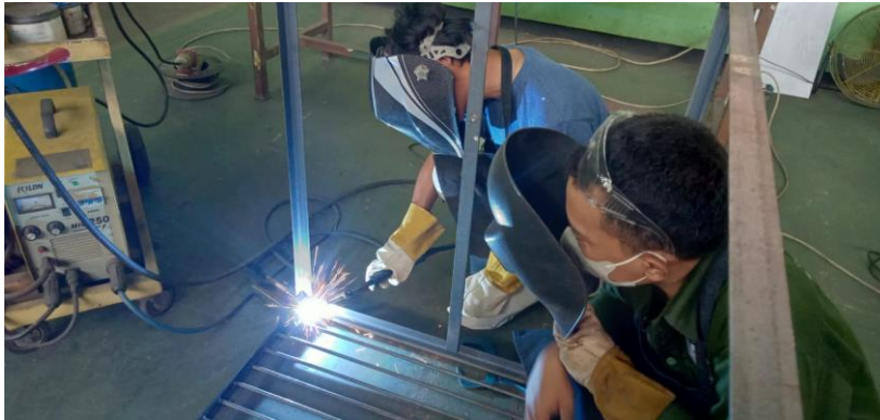
Proses Pengelasan Rangka Mesin ORC
