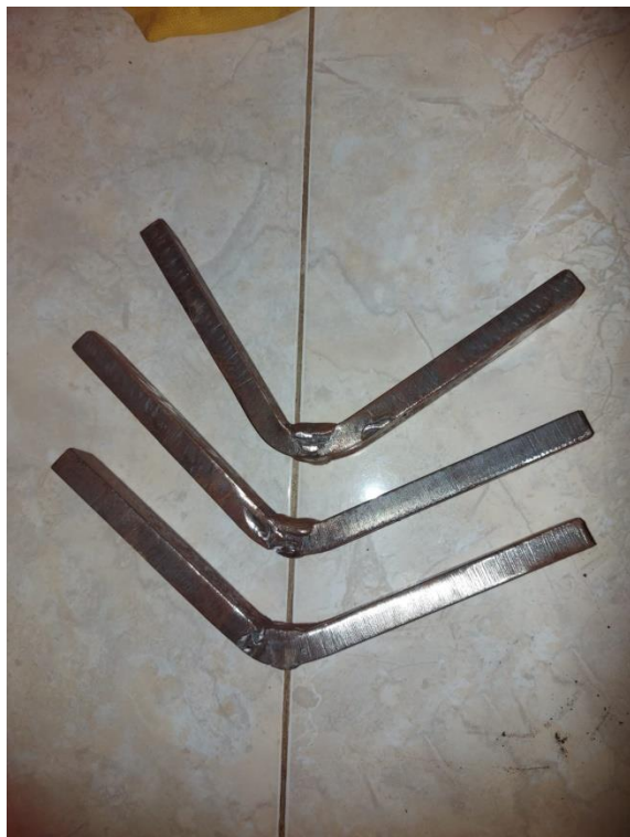
Gambar 8. mesin uji bending dan spesimen uji bending
