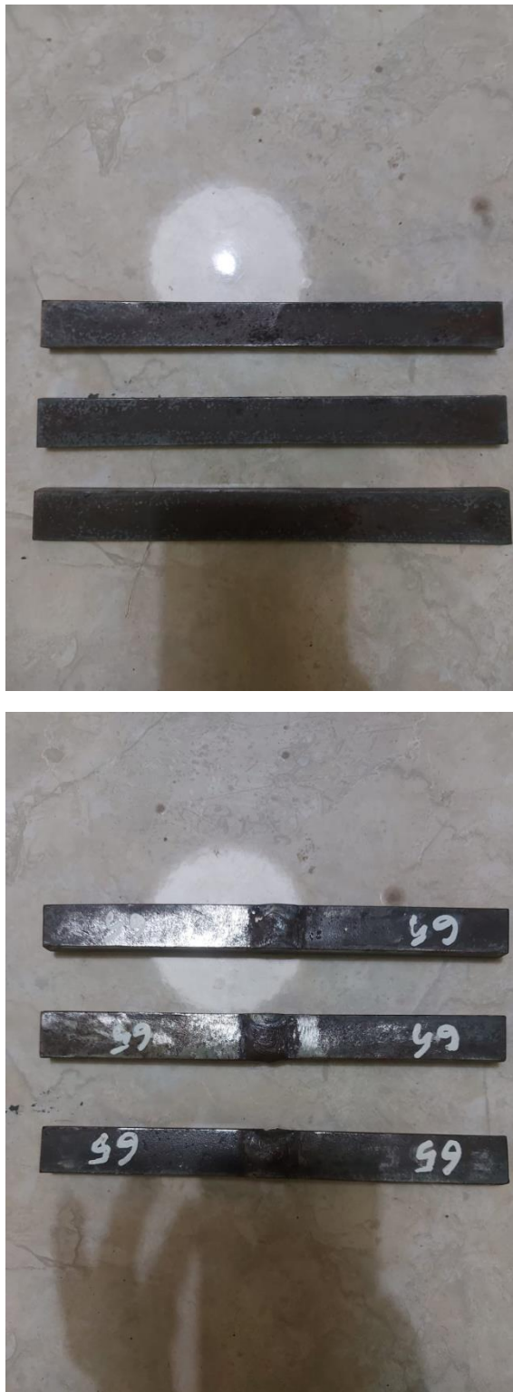
Gambar 3. Spesimen uji bending dengan bahan raw material dan bahan yang di las
