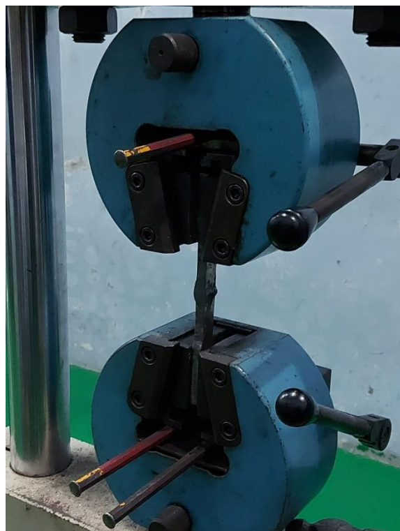
Gambar 6. mesin uji impact dan spesimen uji tarik
