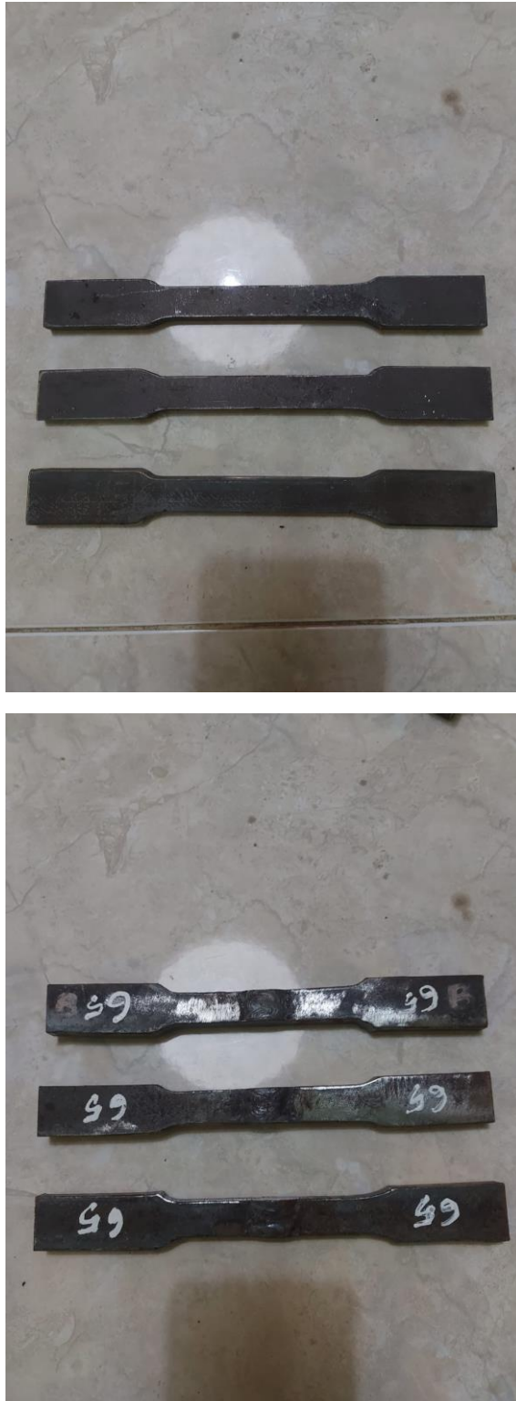
Gambar 1. Spesimen uji tarik dengan bahan raw material dan bahan yang di las
