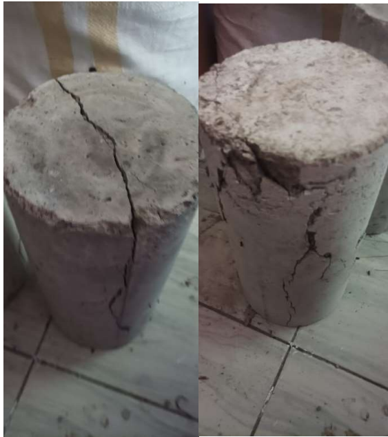
Gambar 5.12 Beton setelah pengujian kuat tekan 15%
