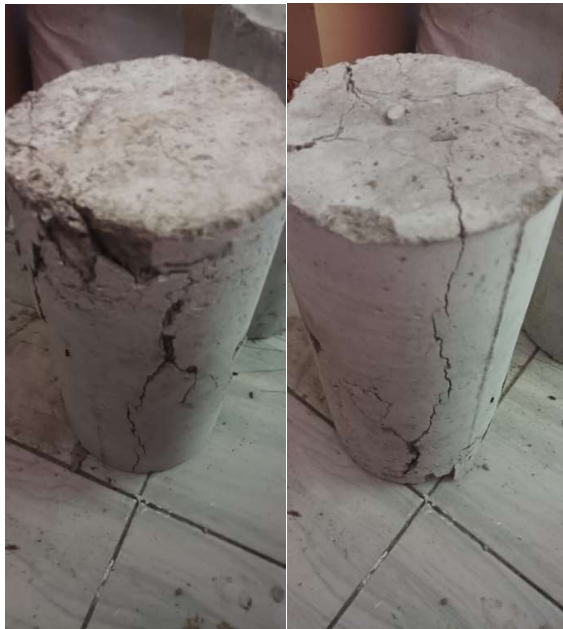
Gambar 5.13 Beton setelah pengujian kuat tekan 20%
