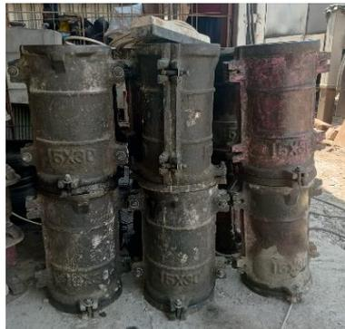
**Gambar 3.12. Cetakan Silinder**
