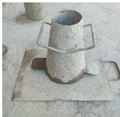
**Gambar 3.10. Kerucut Abrams**
