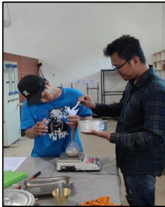
Foto Uji Kadar Lumpur Agregat Kasar
