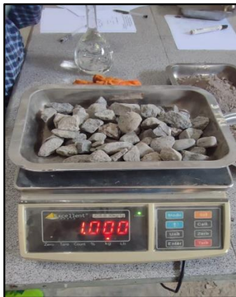
Foto Uji Kadar Lumpur Agregat Kasar
