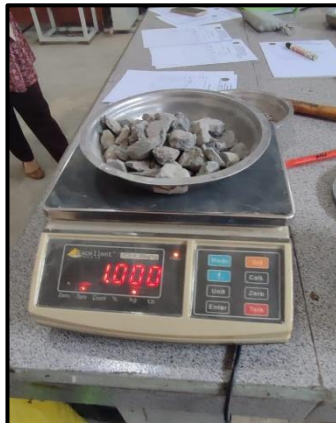
Foto Uji Kadar Lumpur Agregat Kasar
