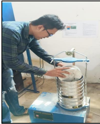
Foto Uji Gradasi Agregat Kasar
