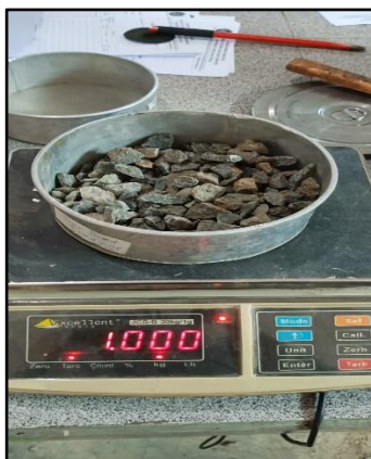
Foto Uji Kadar Air Agregat Kasar
