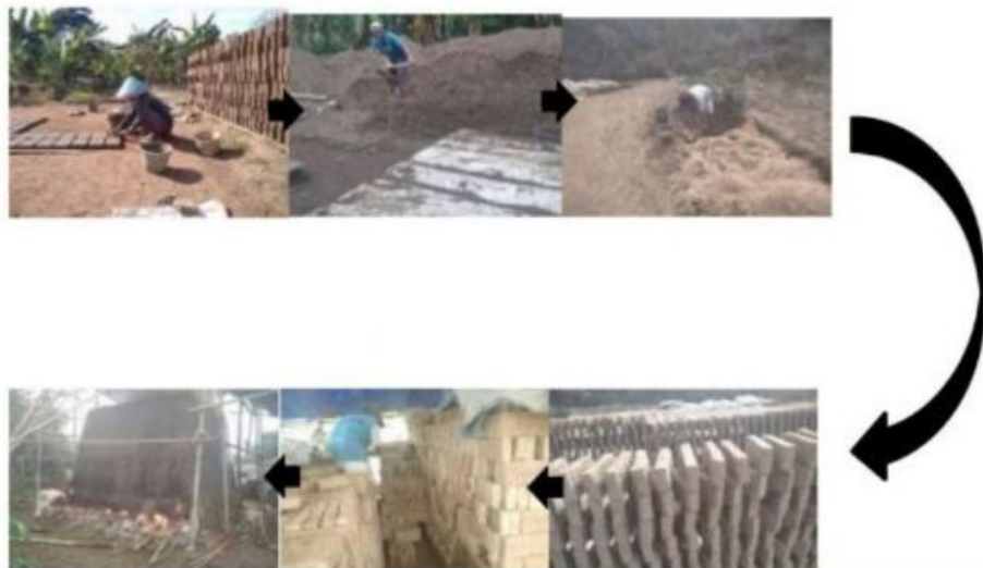
Gambar 2. 9 Tahapan Pembuatan Batu Bata
