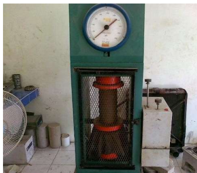
Gambar 3.12 Mesin Uji Kuat Tekan
