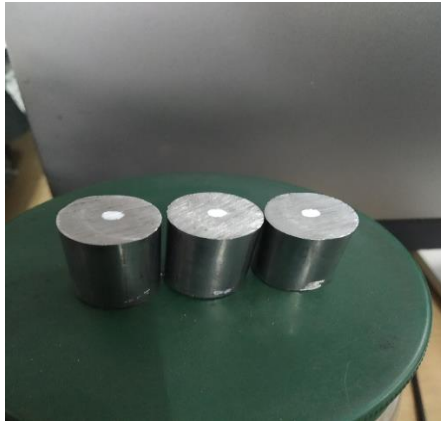
Gambar 3. 6. Spesimen Baja Karbon Rendah ST-41. (Sumber : Dokumentasi Pribadi)
