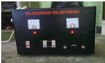
Gambar 3. 3. Trafo Rectifier ( Sumber : Dokumentasi Pribadi )
