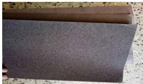
Gambar 3. 5. Amplas Besi. (Sumber : Dokumentasi Pribadi)
