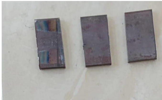
Gambar 3.6 Spesimen Plat Baja Karbon Rendah ST 37
