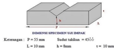
Gambar 3.23 Dimensi spesimen uji impact
