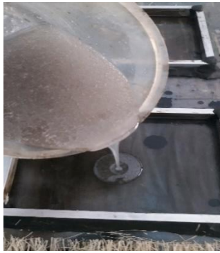
Gambar 3.21 Proses Penuangan Resin Epoxy
