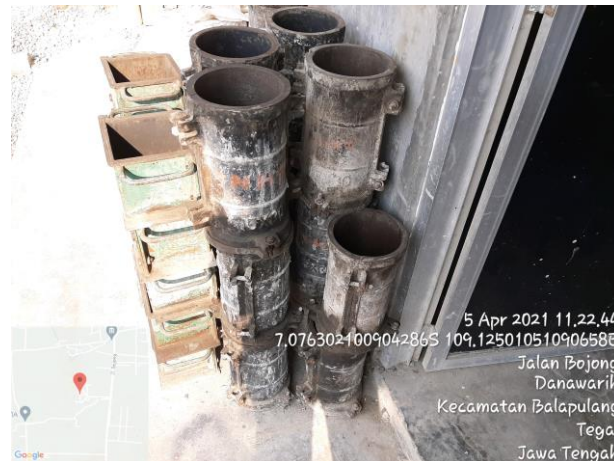
Gambar 3.3 Cetakan Silinder Beton.
