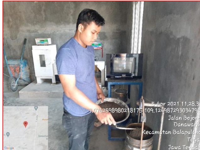
Masukan Pasir Ke Alat Uji Gradasi
