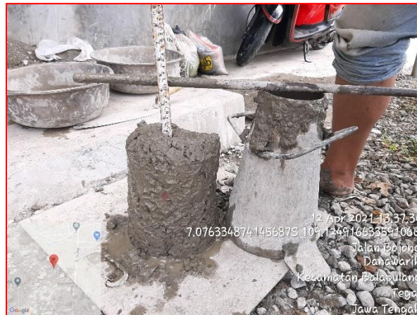
Uji Slump Test Beton Segar
