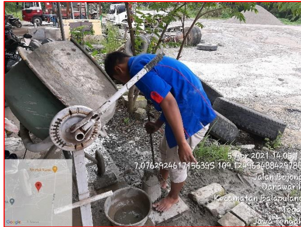
Proses Penumbukan Beton Segar Slum Test
