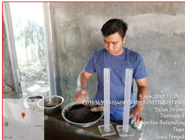
Uji Kadar Lumpur Pasir
