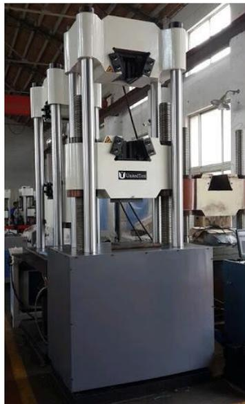
Gambar 3.6. Alat uji bending
