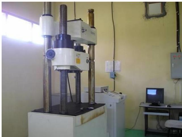
Gambar 2.8. Mesin uji tarik
