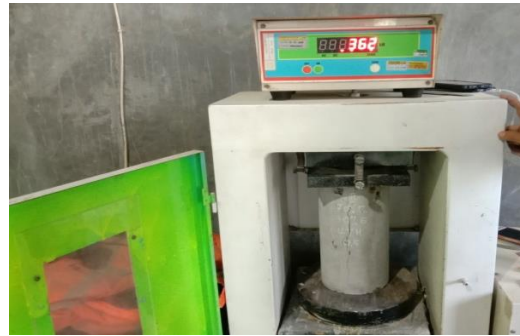
50 . Uji Kuat Tekan Beton(Umur 14 Hari Sampel 2)
