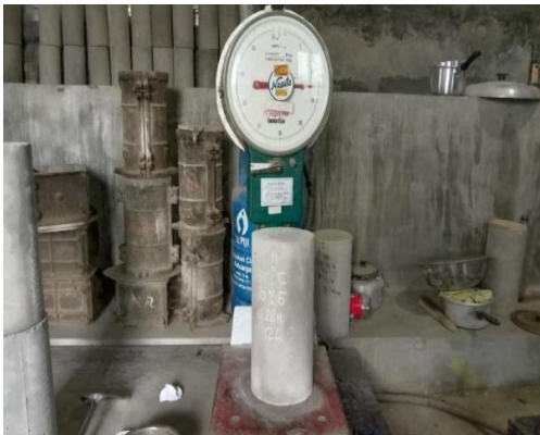
41. Penimbangan Sampel Silinder 7 Hari
