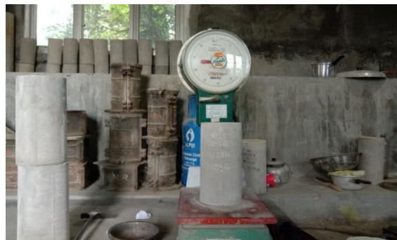
56. Penimbangan Sampel Silinder 14 Hari
