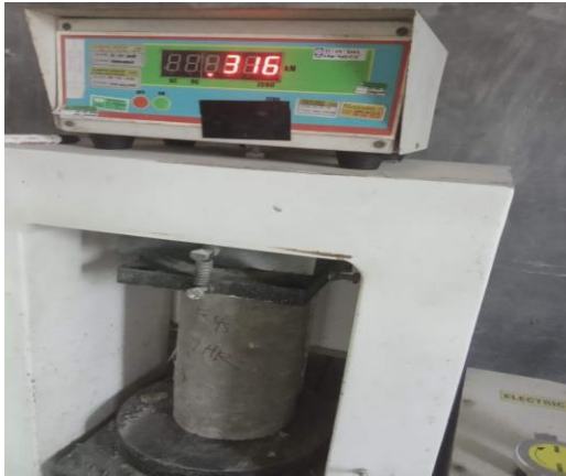
43. Uji Kuat Tekan Beton(Umur 7 Hari Sampel 2)
