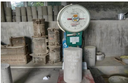
54 . Penimbangan Sampel Silinder 28 Hari
