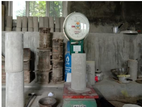
56. Penimbangan Sampel Silinder 14 Hari
