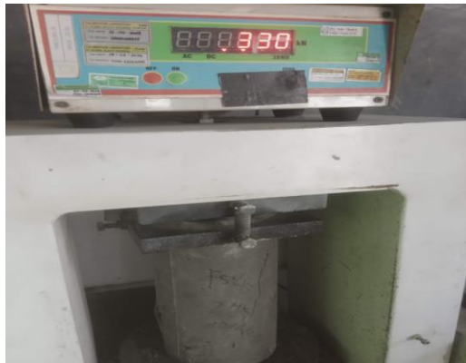
42. Uji Kuat Tekan Beton(Umur 7 Hari Sampel 1)
