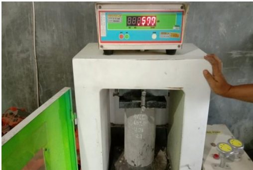
57 . Uji Kuat Tekan Beton(Umur 28 Hari Sampel 3)
