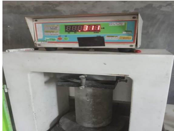
44. Uji Kuat Tekan Beton(Umur 7 Hari Sampel 3)
