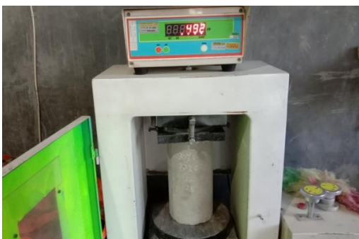
51 . Uji Kuat Tekan Beton(Umur 14 Hari Sampel 3)
