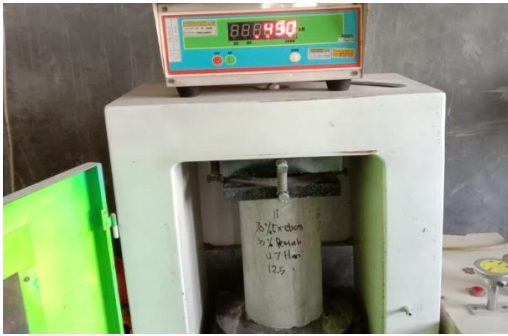
49 . Uji Kuat Tekan Beton(Umur 14 Hari Sampel 1)
