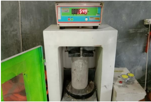
55 . Uji Kuat Tekan Beton(Umur 28 Hari Sampel 1)
