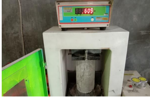
56 . Uji Kuat Tekan Beton(Umur 28 Hari Sampel 2)
