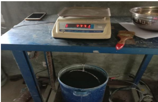
25. Uji Penyerapan Agregat Kasar
