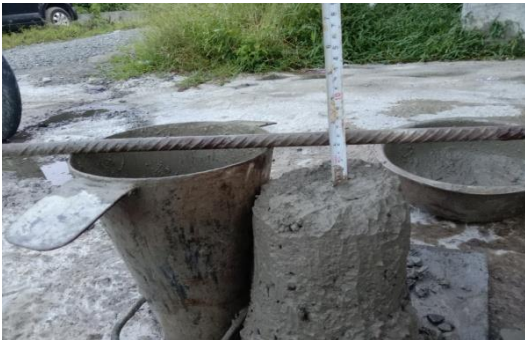
31. Slump Test Beton Segar
