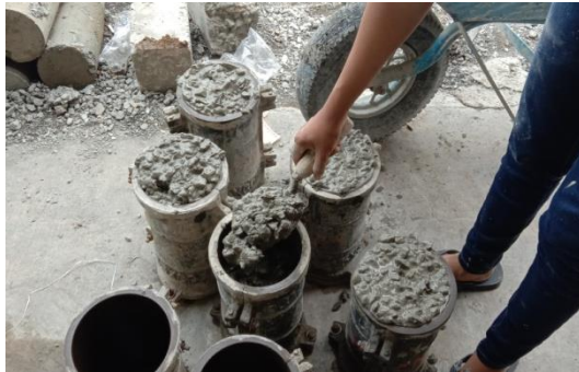
32. Pencetakan Benda Uji
