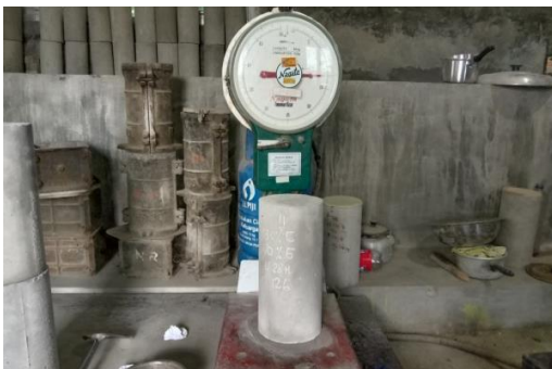
53 . Penimbangan Sampel Silinder 28 Hari
