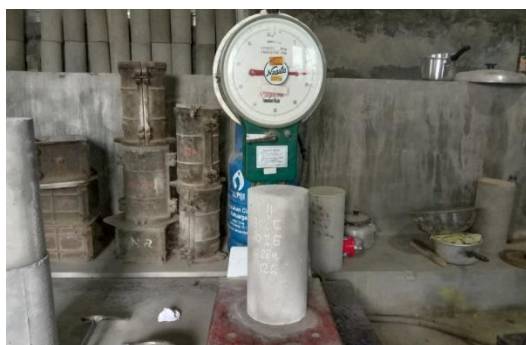
52 . Penimbangan Sampel Silinder 28 Hari
