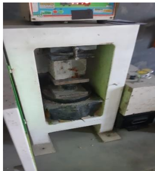
35. Uji Kuat Tekan Beton Varian 1 50% Limbah-50% Murni (Umur 7 Hari Sampel 1)
