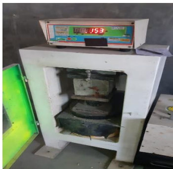
47. Uji Kuat Tekan Beton Varian 2 50% Limbah-50% Murni (Umur 28 Hari Sampel 1)
