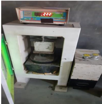
49. Uji Kuat Tekan Beton Varian 2 50% Limbah-50% Murni (Umur 28 Hari Sampel 3)
