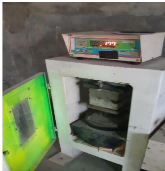
39. Uji Kuat Tekan Beton Varian 2 80% Limbah-20% Murni (Umur 7 Hari Sampel 2)
