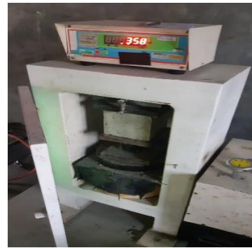
52. Uji Kuat Tekan Beton Varian 2 80% Limbah-20% Murni (Umur 28 Hari Sampel 3)
