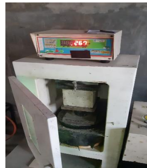
36. Uji Kuat Tekan Beton Varian 1 50% Limbah-50% Murni (Umur 7 Hari Sampel 2)
