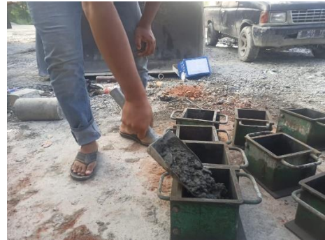
26. Pencetakan Benda Uji
