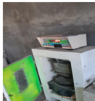
42. Uji Kuat Tekan Beton Varian 1 50% Limbah-50% Murni (Umur 14 Hari Sampel 2)
