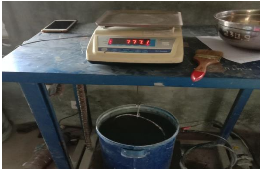
21. Uji Penyerapan Agregat Kasar
