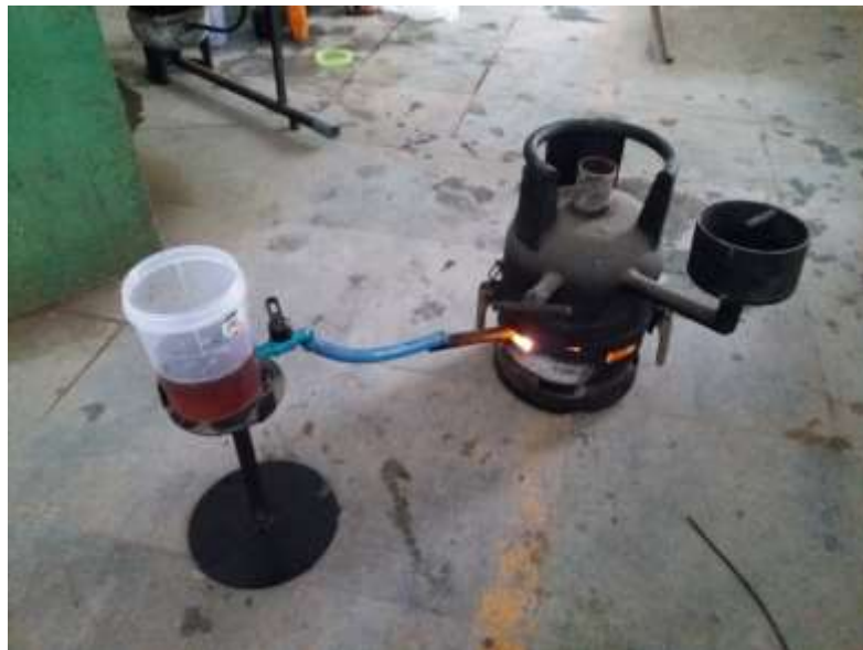
Proses Percobaan Dengan Menggunakan Bahan Bakar Minyak Jelantah
