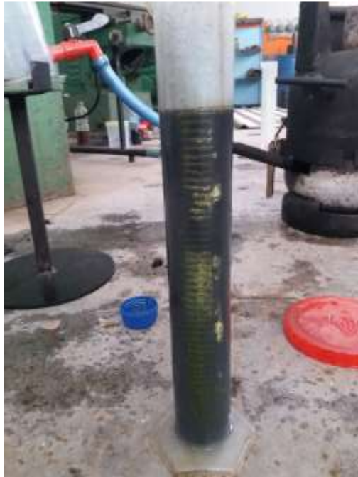
Pengukuran Bahan Bakar Oli Bekas Dengan Gelas Ukur
