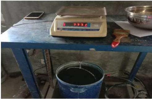
25. Uji Penyerapan Agregat Kasar
