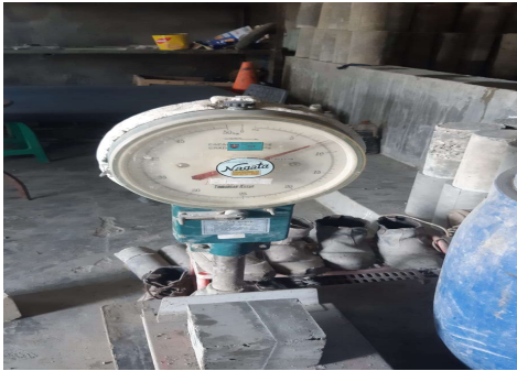
39. Penimbangan Sampel kubus 14 Hari sampel 80%-20%
