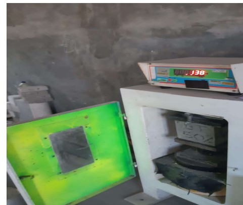
36. Uji Kuat Tekan Beton 50%-50% (Umur 7 Hari Sampel 2)
