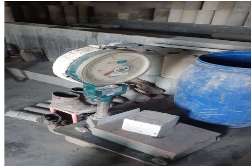
40. Penimbangan Sampel kubus 28 Hari sampel 80%-20%
