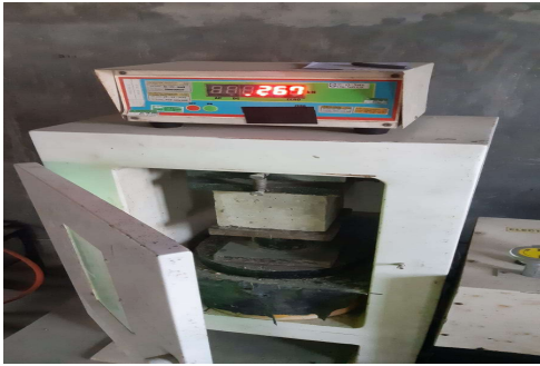
49 . Uji Kuat Tekan Beton 80%-20% (Umur 28 Hari Sampel 3)
