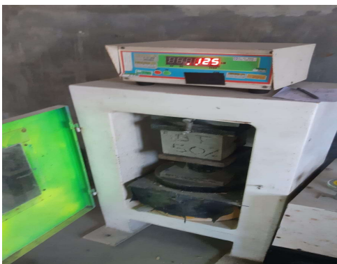
41 . Uji Kuat Tekan Beton 80%-20% (Umur 7 Hari Sampel 1)
