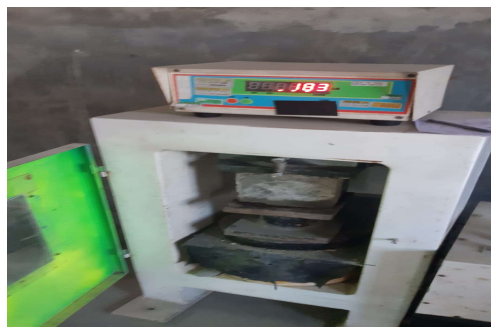
48 . Uji Kuat Tekan Beton 80%-20% (Umur 28 Hari Sampel 2)
