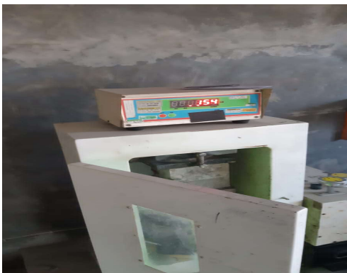
35. Uji Kuat Tekan Beton 50%-50% (Umur 7 Hari Sampel 1)
