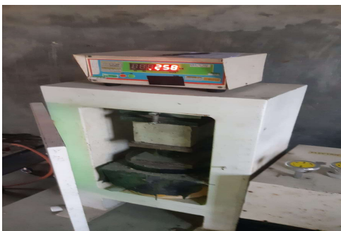
47 . Uji Kuat Tekan Beton 80%-20% (Umur 28 Hari Sampel 1)
