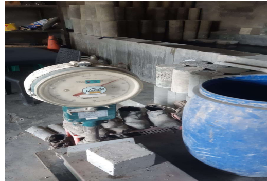
38. Penimbangan Sampel kubus 7 Hari sampel 80%-20%
