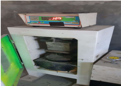
37. Uji Kuat Tekan Beton 50%-50% (Umur 7 Hari Sampel 3)
