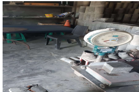
32. Penimbangan Sampel kubus 7 Hari sampel 50%-50%
