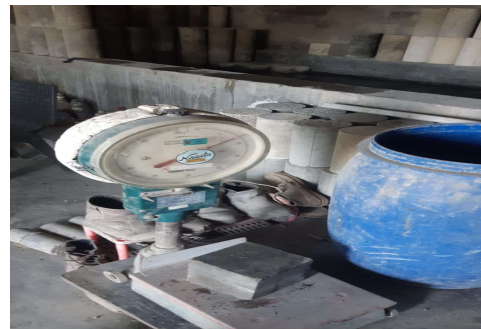
34. Penimbangan Sampel kubus 28 Hari sampel 50%-50%
