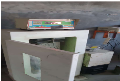
45 . Uji Kuat Tekan Beton 80%-20% (Umur 14 Hari Sampel 2)
