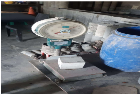
33. Penimbangan Sampel kubus 14 Hari sampel 50%-50%
