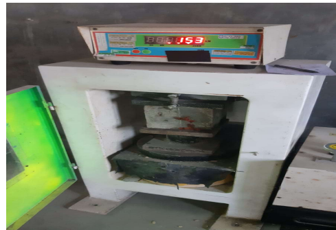
44 . Uji Kuat Tekan Beton 80%-20% (Umur 14 Hari Sampel 1)
