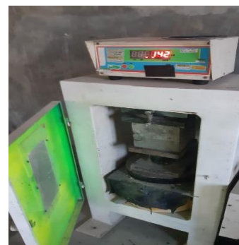
14. Uji Kuat Tekan Beton Varian 2 80% Limbah-20% Murni (Umur 14 Hari Sampel 1)
