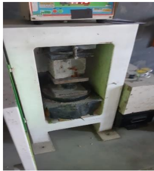
5. Uji Kuat Tekan Beton Varian 1 50% Limbah-50% Murni (Umur 7 Hari Sampel 1)
