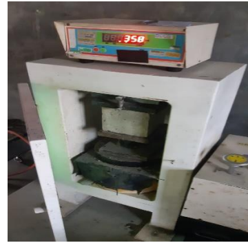
22. Uji Kuat Tekan Beton Varian 2 80% Limbah-20% Murni (Umur 28 Hari Sampel 3)
