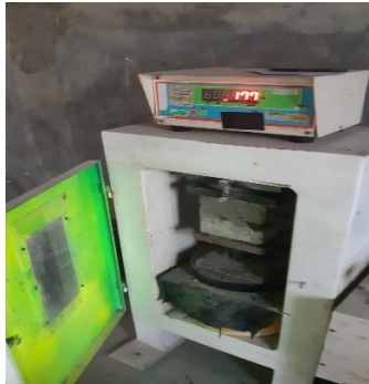
9. Uji Kuat Tekan Beton Varian 2 80% Limbah-20% Murni (Umur 7 Hari Sampel 2)
