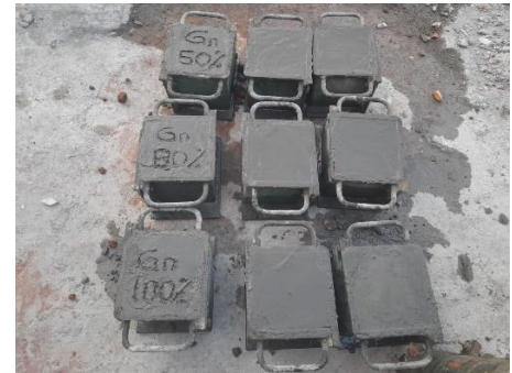
28. Sampel Kubus Beton
