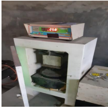
21. Uji Kuat Tekan Beton Varian 2 80% Limbah-20% Murni (Umur 28 Hari Sampel 2)
