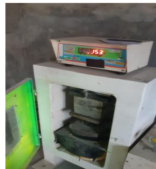
8. Uji Kuat Tekan Beton Varian 2 80% Limbah-20% Murni (Umur 7 Hari Sampel 1)
