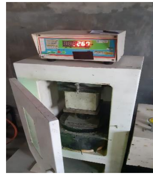
6. Uji Kuat Tekan Beton Varian 1 50% Limbah-50% Murni (Umur 7 Hari Sampel 2)
