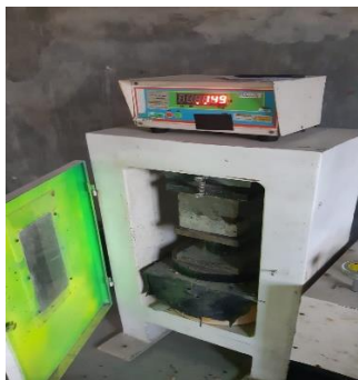
7. Uji Kuat Tekan Beton Varian 1 50% Limbah-50% Murni (Umur 7 Hari Sampel 3)
