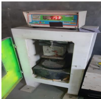
17. Uji Kuat Tekan Beton Varian 2 50% Limbah-50% Murni (Umur 28 Hari Sampel 1)
