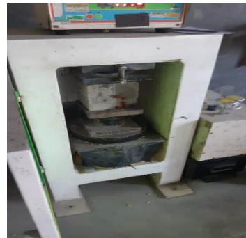
18. Uji Kuat Tekan Beton Varian 2 50% Limbah-50% Murni (Umur 28 Hari Sampel 2)
