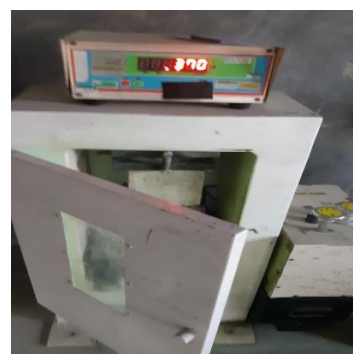
20. Uji Kuat Tekan Beton Varian 2 80% Limbah-20% Murni (Umur 28 Hari Sampel 1)
