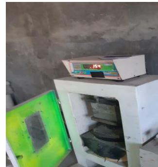
12. Uji Kuat Tekan Beton Varian 1 50% Limbah-50% Murni (Umur 14 Hari Sampel 2)
