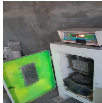
16. Uji Kuat Tekan Beton Varian 2 80% Limbah-20% Murni (Umur 14 Hari Sampel 3)
