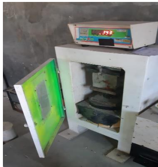
11. Uji Kuat Tekan Beton Varian 1 50% Limbah-50% Murni (Umur 14 Hari Sampel 1)
