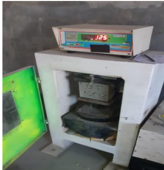
15. Uji Kuat Tekan Beton Varian 2 80% Limbah-20% Murni (Umur 14 Hari Sampel 2)
