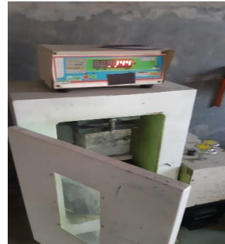
10. Uji Kuat Tekan Beton Varian 2 80% Limbah-20% Murni (Umur 7 Hari Sampel 3)
