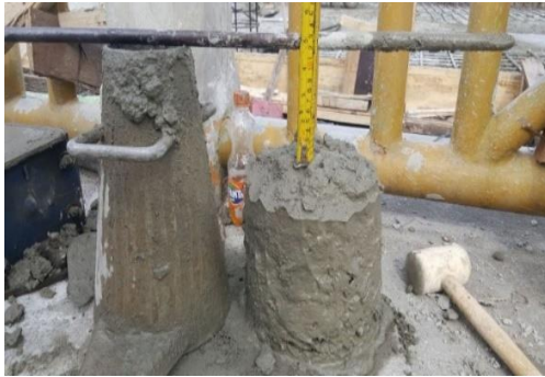
25. Slump Test Beton Segar
