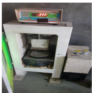
19. Uji Kuat Tekan Beton Varian 2 50% Limbah-50% Murni (Umur 28 Hari Sampel 3)
