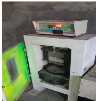
37. Uji Kuat Tekan Beton Varian 1 50% Limbah-50% Murni (Umur 7 Hari Sampel 3)
