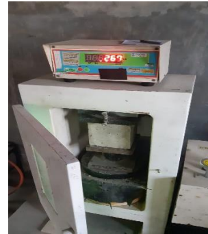
36. Uji Kuat Tekan Beton Varian 1 50% Limbah-50% Murni (Umur 7 Hari Sampel 2)
