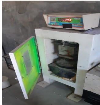
41. Uji Kuat Tekan Beton Varian 1 50% Limbah-50% Murni (Umur 14 Hari Sampel 1)
