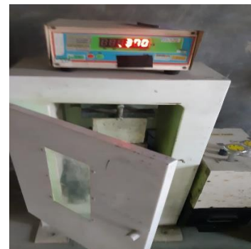
50. Uji Kuat Tekan Beton Varian 2 80% Limbah-20% Murni (Umur 28 Hari Sampel 1)
