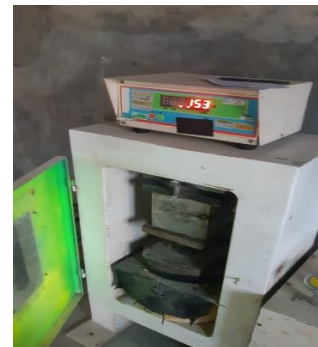
38. Uji Kuat Tekan Beton Varian 2 80% Limbah-20% Murni (Umur 7 Hari Sampel 1)
