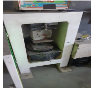
48. Uji Kuat Tekan Beton Varian 2 50% Limbah-50% Murni (Umur 28 Hari Sampel 2)
