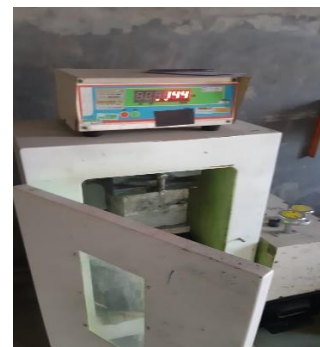
40. Uji Kuat Tekan Beton Varian 2 80% Limbah-20% Murni (Umur 7 Hari Sampel 3)
