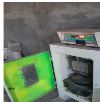
46. Uji Kuat Tekan Beton Varian 2 80% Limbah-20% Murni (Umur 14 Hari Sampel 3)
