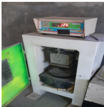
45. Uji Kuat Tekan Beton Varian 2 80% Limbah-20% Murni (Umur 14 Hari Sampel 2)
