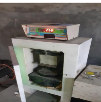
51. Uji Kuat Tekan Beton Varian 2 80% Limbah-20% Murni (Umur 28 Hari Sampel 2)
