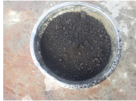
18. Agregat Halus Eks Muntilan
