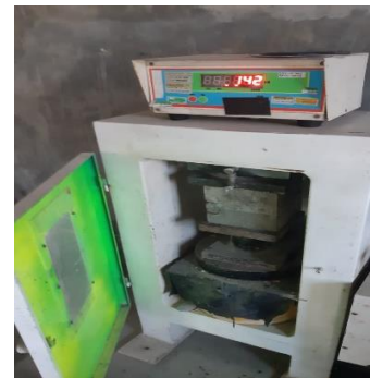
44. Uji Kuat Tekan Beton Varian 2 80% Limbah-20% Murni (Umur 14 Hari Sampel 1)
