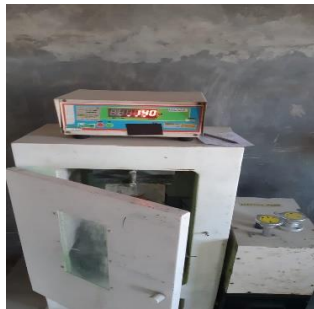
43. Uji Kuat Tekan Beton Varian 1 50% Limbah-50% Murni (Umur 14 Hari Sampel 3)
