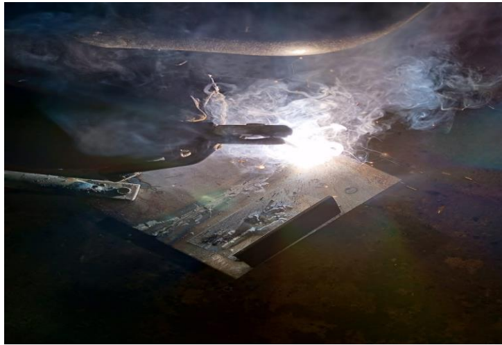
Gambar 1 : Proses Pengelasan Pembuatan Spesimen
