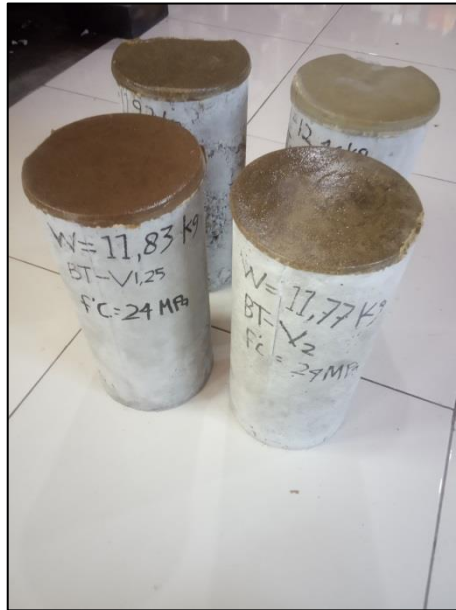
GAMBAR L11. SEMPEL BETON YANG SUDAH DICAPPING
