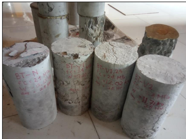
GAMBAR L16. KERETAKAN PADA SEMPEL BETON SETELAH DITEST KUAT TEKAN DENGAN CTM (2000 KN)
