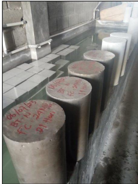
GAMBAR L9. SEMPEL BETON SETELAH PERENDAMAN
