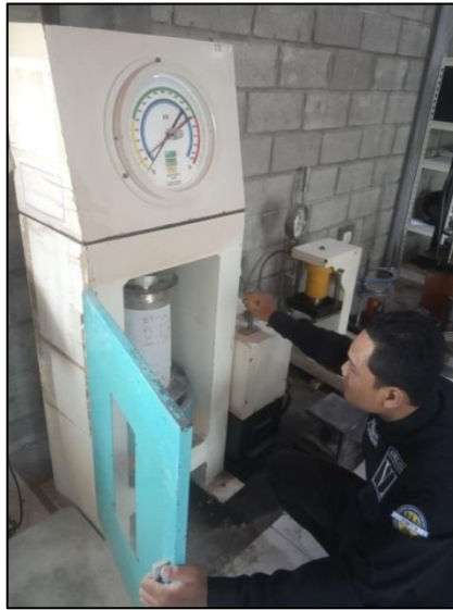
GAMBAR L13. TEST SEMPEL BETON DENGAN ALAT CTM LISTRIK (2000KN)
