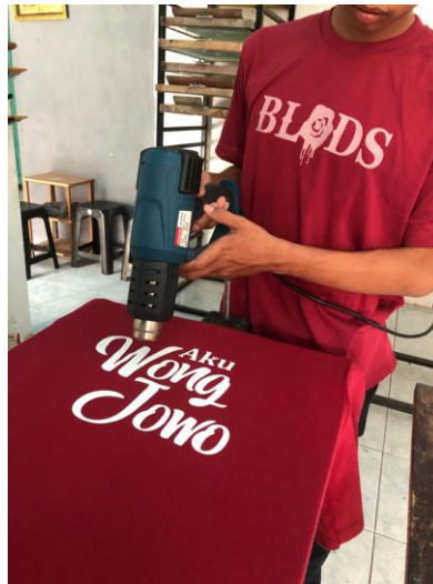
Gambar 3.1 Kondisi Pengeringan Menggunakan Heatgun
