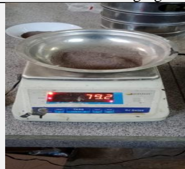
Proses Gradasi Agregat Halus
