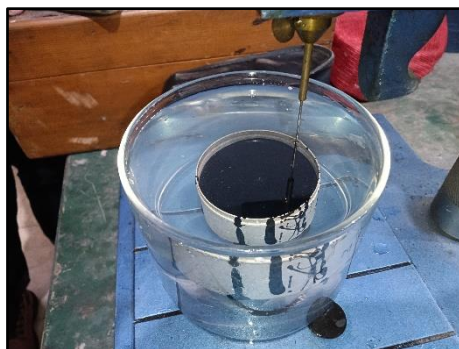
Gambar 3. 92 Jarum Menyentuh Permukaan Aspal
