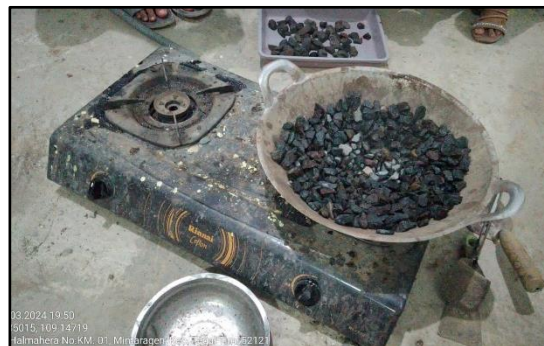
Gambar 3. 33 Mengeringkan Agregat setelah Dicuci (Sumber : Dokumentasi Pribadi)
