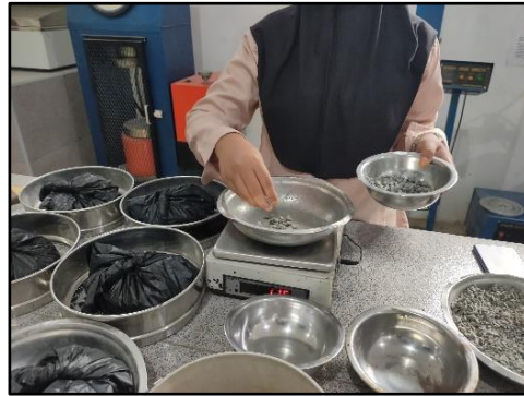
Gambar 3. 54 Menimbang Agregat sesuai Job Mix
