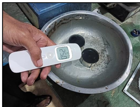
Gambar 3. 89 Merendam Aspal pada Suhu 25°C
