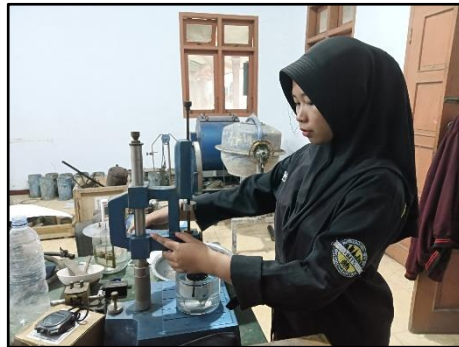
Gambar 3. 91 Mengatur Alat Penetrometer
