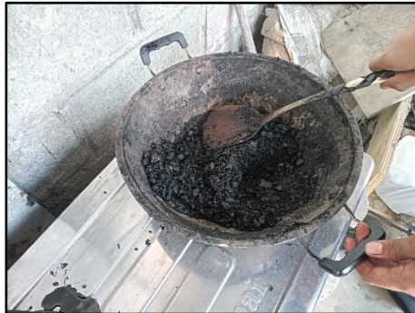
Gambar 3. 60 Mengaduk Campuran Agregat dengan Aspal (Sumber : Dokumentasi Pribadi)
