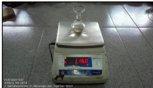
Gambar 3. 105 Berat Piknometer + Air ( B ) (Sumber : Dokumentasi Pribadi)
