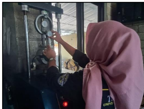
Gambar 3. 76 Memasang Arloji Flow pada Tempatnya (Sumber : Dokumentasi Pribadi)
