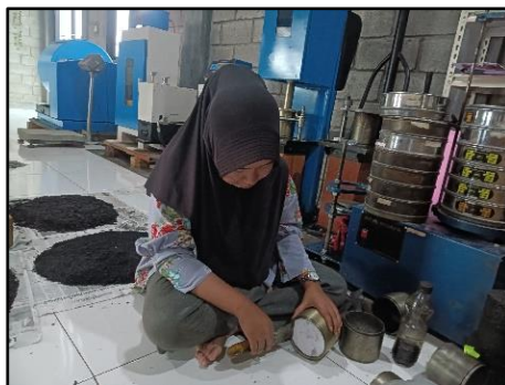
Gambar 3. 64 Melepaskan Kertas Penghisap (Sumber : Dokumentasi Pribadi)
