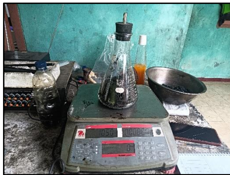
Gambar 3. 80 Menimbang Berat Tempat + Sampel (A)
