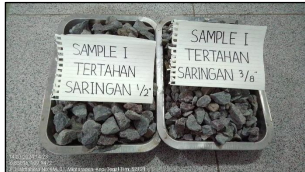
Gambar 3. 34 Sample I Agregat Tertahan Saringan \frac{1}{2} " dan \frac{3}{8} " (Sumber : Dokumentasi Pribadi)
