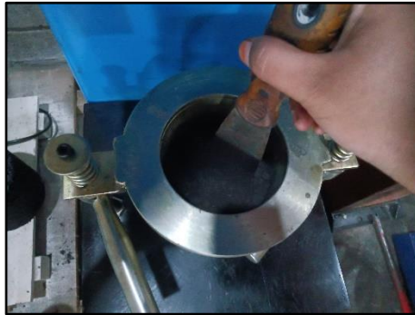
Gambar 3. 62 Masukkan Campuran ke Dalam Cetakan (Sumber : Dokumentasi Pribadi)
