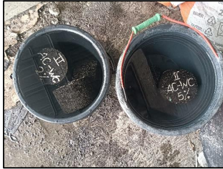
Gambar 3. 70 Merendam Benda Uji selama 10 Menit
