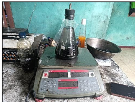
Gambar 3. 85 Menimbang Berat Tempas + Sampel + Air
