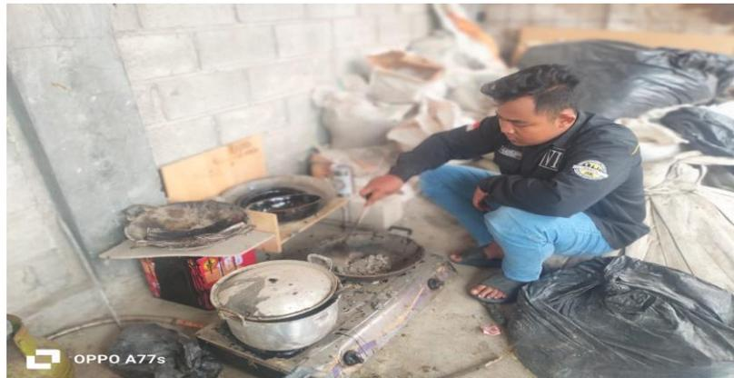
Gambar 3.41 Pencampuran aspal panas
