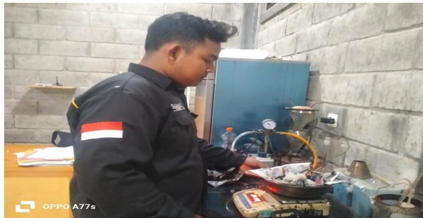
Gambar 3.48 penimbangan agregat
