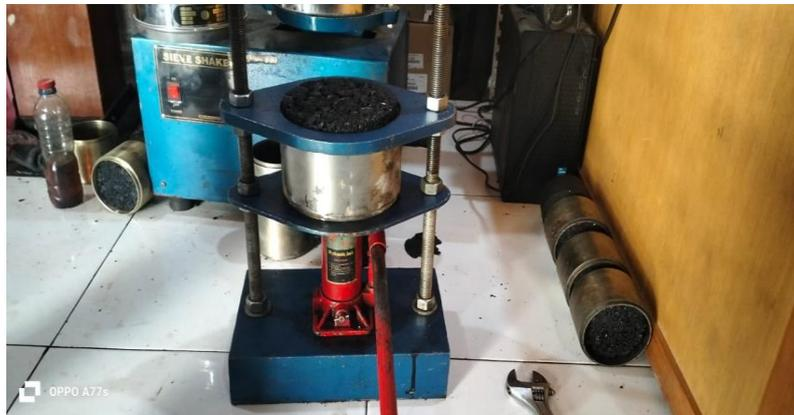
Gambar 3.43 pelepasan benda uji
