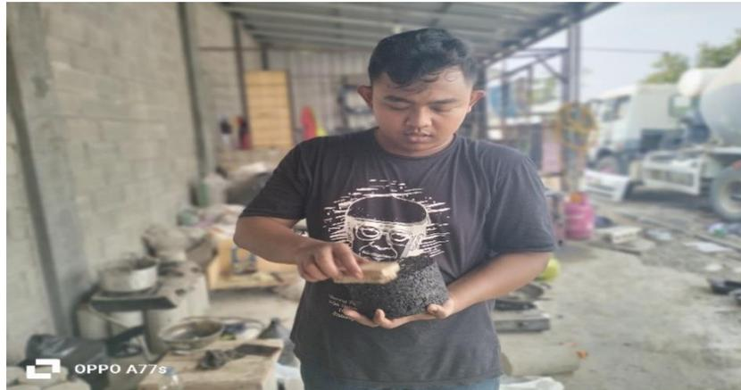
Gambar 3.44 proses pembersihan benda uji
