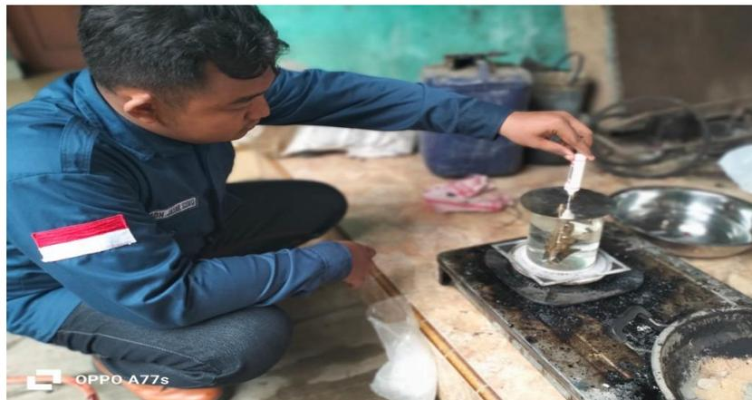
Gambar 3.35 pengujian titik lembek
