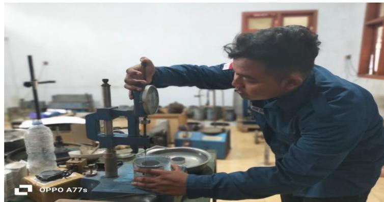
Gambar 3.33 pengujian penetrasi
