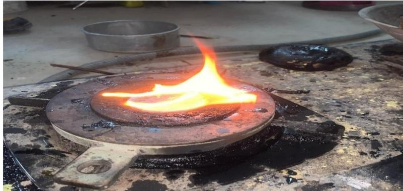
Gambar 3.34 pengujian titik nyala dan bakar
