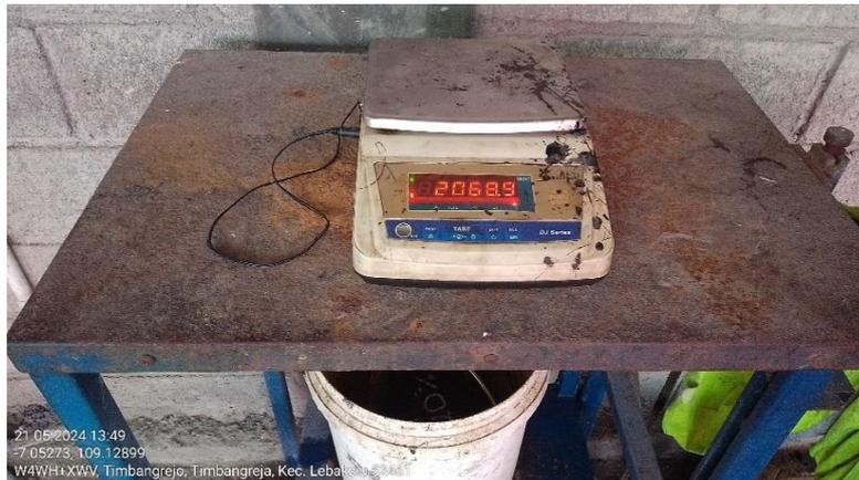
Gambar 3.38 pengujian berat jenis agregat
