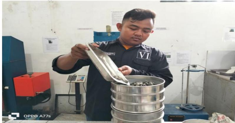
Gambar 3.39 pengujian gradasi
