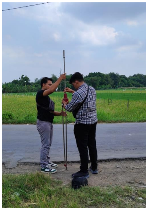
Lampiran 12 Survei kelayakan tanah uji Dynamic Cone Penetrometer (DCP) titik uji ke 3
