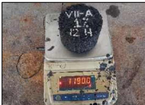
**Gambar 3. 62** Tahap Penimbangan Benda Uji Kering
