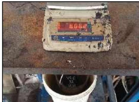
**Gambar 3. 64** Tahap Penimbangan Benda Uji di dalam air
