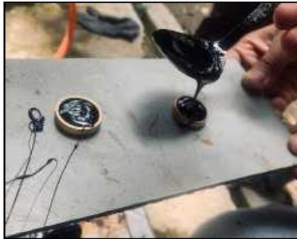
**Gambar 3.20** Tahap Pembuatan benda uji titik lembek
