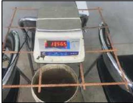
**Gambar 3.37** Tahap Penimbangan agregat di dalam air
