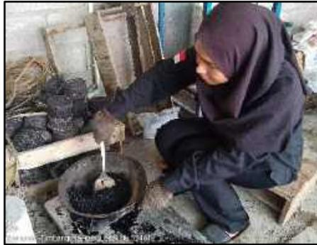
**Gambar 3.53** Tahap Pencampuran Aspal dan agregat
