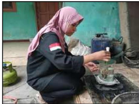
**Gambar 3.22** Tahap Pengujian Titik Lembek
