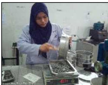
**Gambar 3.31** Tahap Penimbangan Hasil *Grading*
