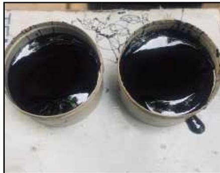
**Gambar 3.11** Tahap Pembuatan Benda Uji Penetrasi
