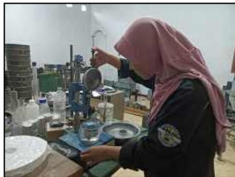
**Gambar 3.14** Tahap Pengujian Penetrasi
