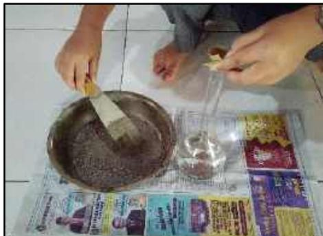
**Gambar 3.42** Tahap memasukkan sampel ke dalam piknometer
