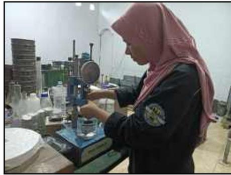
**Gambar 3.13** Tahap Pemasangan Jarum Penetrasi
