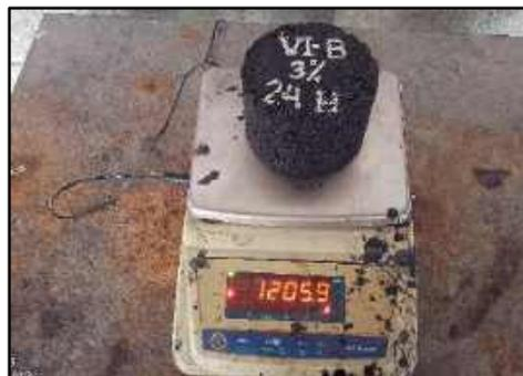
**Gambar 3. 65** Tahap Penimbangan Benda Uji SSD
