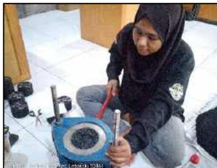
**Gambar 3. 59** Tahap melepaskan benda uji dari  *mold*
