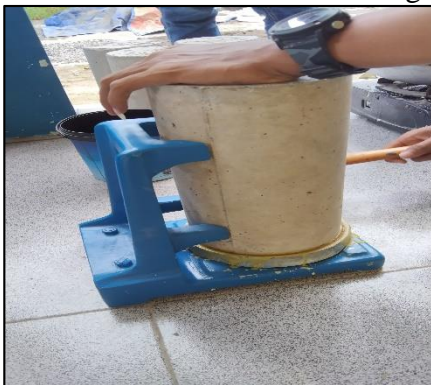
Proses Pemasangan Capping Beton
