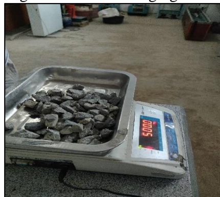
Penimbangan agregat Kasar
