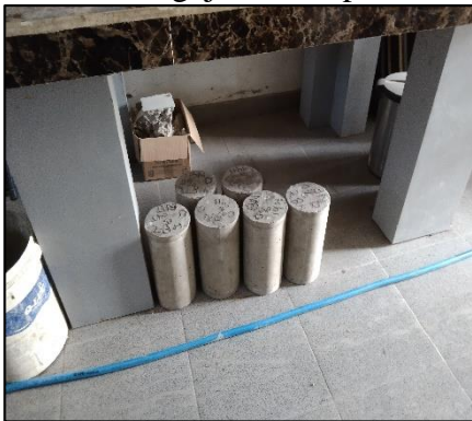
Perawatan Beton di Dalam Ruangan
