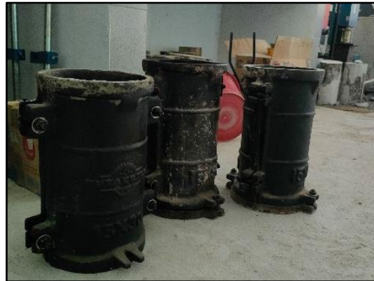
Gambar 3.16 Cetakan silinder berukuran 15 cm x 30 cm
