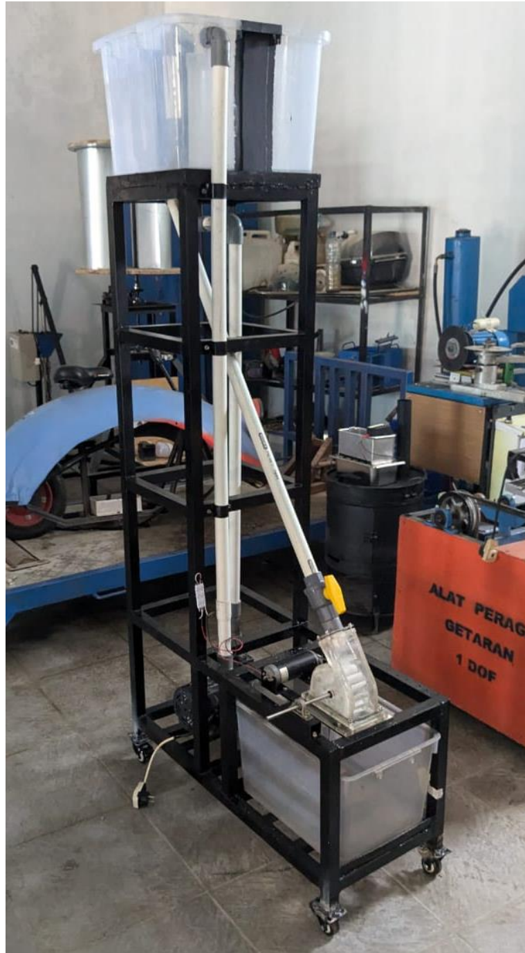
Gambar 3.4 Prototype Pembangkit Listrik Tenaga Mikro Hidro
