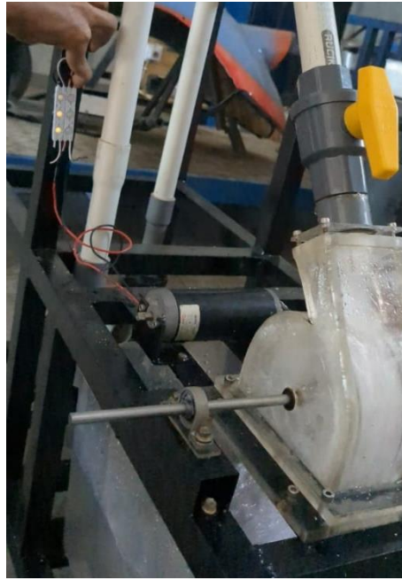
5. Pengujian turbin dengan generator beban lampu Daya 3 Watt
