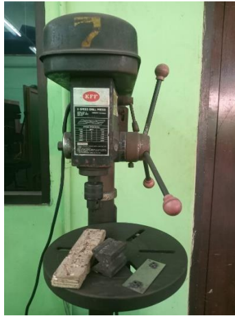
Gambar 3. 6 Mesin Bor Sumber : Dokumentasi Pribadi
