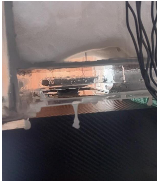
Gamabar 6. Kebocoran alat uji termal menggunakan bahan akrilik
