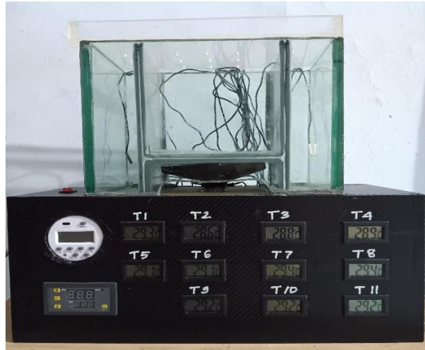
Gambar 1. Alat uji termal menggunakan bahan kaca (sumber: dokumen pribadi)
