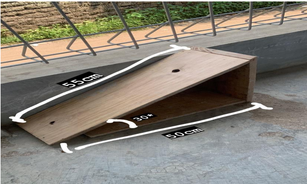
Lampiran 6. Alat uji koefisien gesek (bidang miring)
